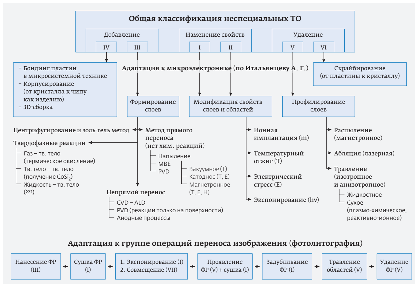
Рис. 11. Общая классификация ТО, адаптированная к микроэлектронике и, в частности, к сложной операции фотолитографии (переноса изображения). MBE – молекулярно-лучевая эпитаксия, PVD – физическое осаждение из газовой фазы, CVD – химическое осаждение из газовой фазы, ALD – атомно-слоевое осаждение. ФР – фоторезист. Твердофазные реакции типа «жидкость – твердое тело» пока не внедрены в микроэлектронику, что отображено на схеме как «???». В схеме перечислены только основные технологические альтернативы
