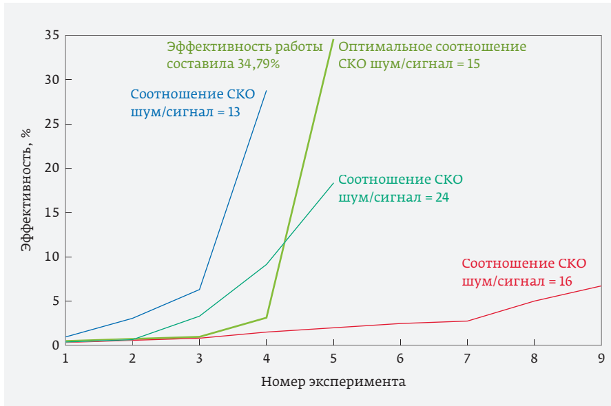
Рис. 5. Определение оптимального значения соотношения шум/сигнал
