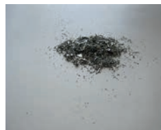
Рис. 5 Платина, извлеченная фильтрацией из диметилформамида после проведения «взрыва»
