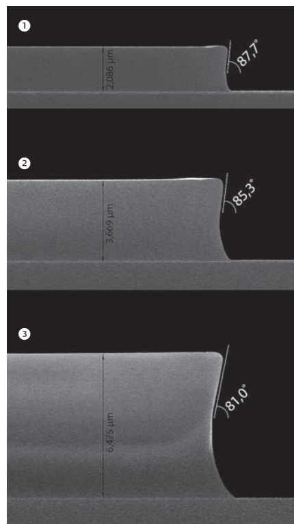
Рис. 1. Профили скола маски фоторезистов ФН-16У-2 (1), ФН-16У-4 (2) и ФН-16У-7 (3), полученной проявлением скрытого изображения, сформированного методом контактной печати
